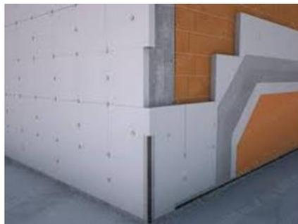
Sistema di isolamento termico a cappotto, completo di finitura silossanica con INTONACO SILOSSANICO prodotto dalla Steplast Srl, previa applicazione di fondo isolante FIX STEP PRIMA MANO prodotto da Steplast Srl, per pareti e soffitti esterni costituiti da pannelli in EPS 100 con grafite prodotto da S.T.S. Polistiroli a marchio CE, intonacabile, conforme alla normativa EPS-EN 13163, L2-W2-T2-S2-P4-DS(N)2-DS(70-)1-TR150-BS100, sp. 14 cm (cappotto di facciata).
